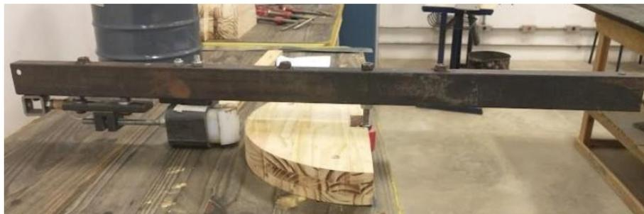
Figura 4 - Visão do contato entre o equipamento de vergamento e o corpo de prova (a) e representação esquemática do equipamento de vergamento (b)
